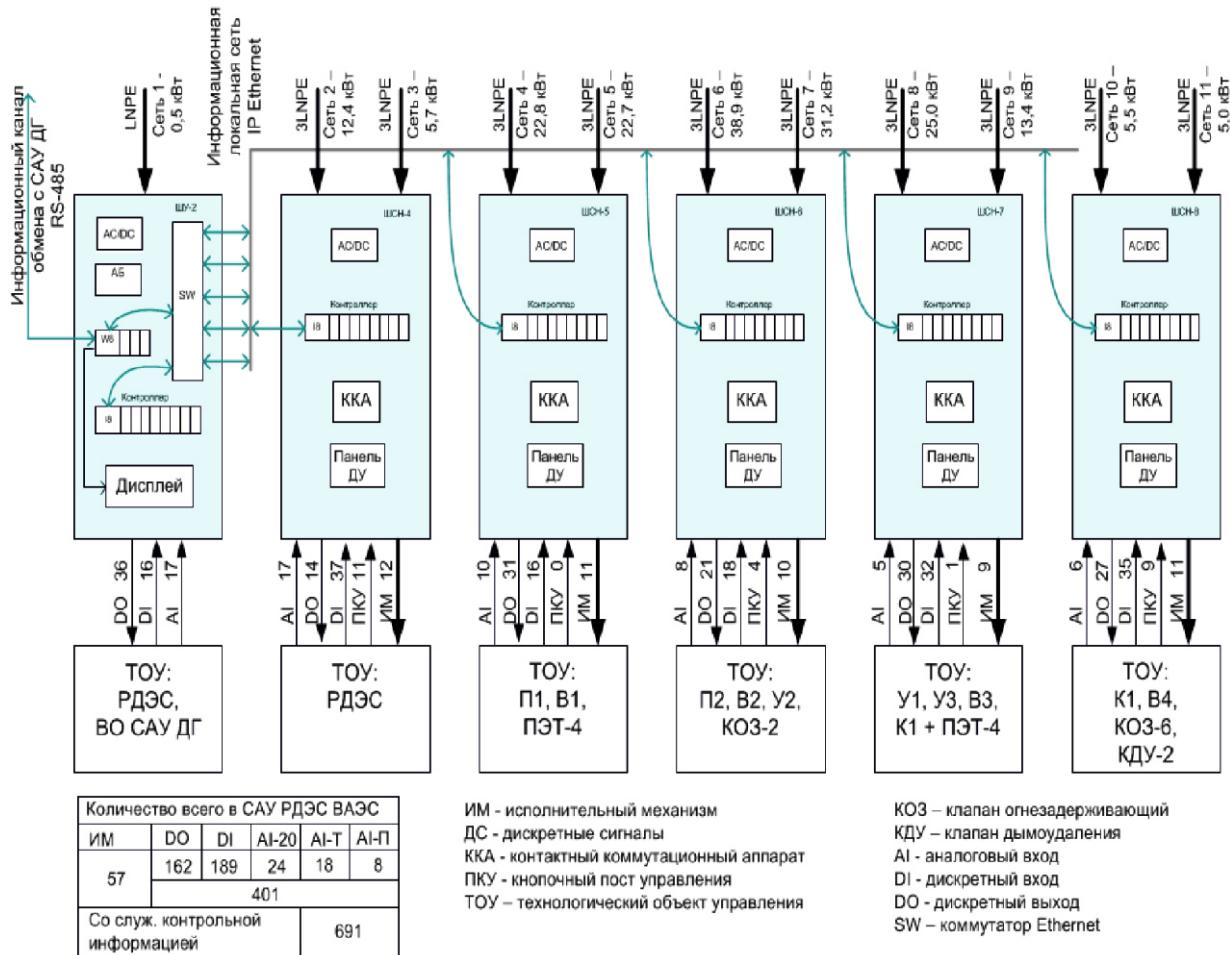
Аппаратура САУ ВО прошла все необходимые испытания и разрешена для автоматизации объектов АЭС 2 - 4 классов безопасности. Многолетняя эксплуатация САУ ВО подтвердила их соответствие всем требованиям АЭС.
